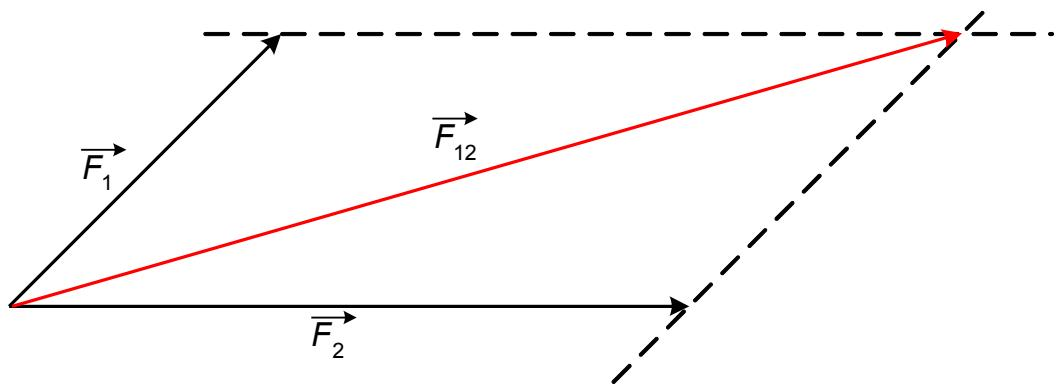
Die Ersatzkraft  $F_{12}$  hat die gleiche Wirkung wie die beiden Kräfte  $F_1$  und  $F_2$  zusammen.
